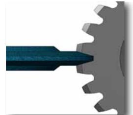
Schleifscheiben zum diskontinuierlichen Wälz- oder Profilschleifen
